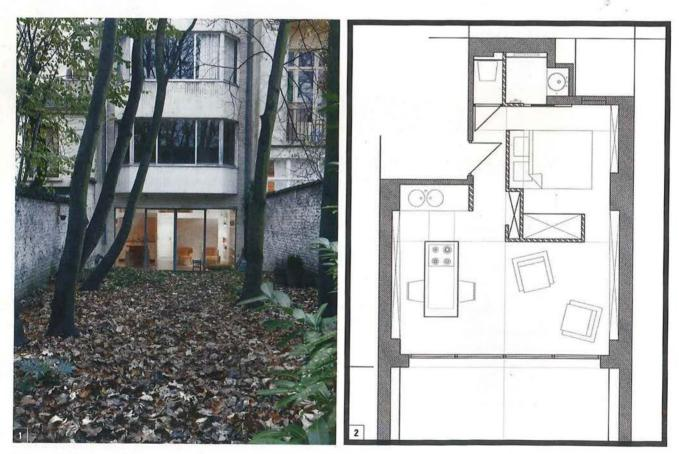
1. Pour optimiser la sensation d'espace, l'architecte a atténué le plus possible la rupture entre l'intérieur et l'extérieur du studio. De grandes baies vitrées ont été installées. Le même matériau à été utilisé pour la terrasse et le sol de l'habitation dans le but d'assurer une continuité: du béton poli. Enfin, les profils des châssis ont été intégrés dans le sol afin de décloisonner au maximum l'ouverture vers le jardin. L'acier a été préféré au bois pour sa finesse.
